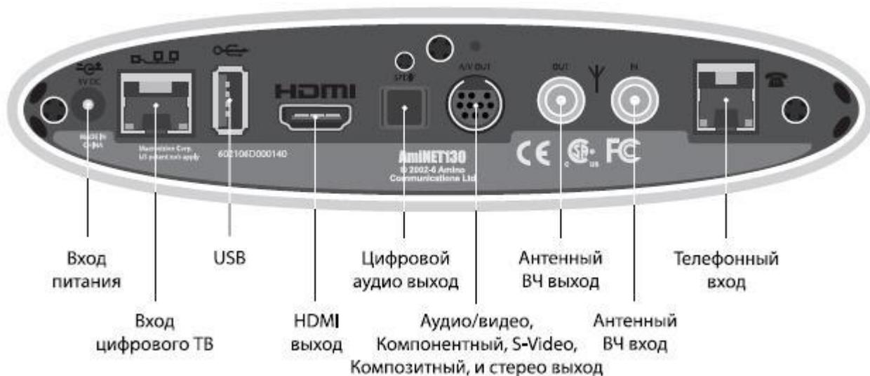
Выполнив следующие инструкции, вы легко и быстро установите AmiNET130. Для подключения AmiNET130 к телевизору можно использовать A/V-кабель Amino (прилагается), кабель HDMI или антенный кабель. Если у вас есть такая возможность, то AmiNET130 также можно подключить к стерео усилителю через цифровой выходной разъем S/PDIF.
